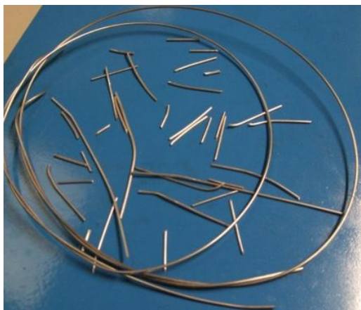
加工中に破断したマグネシウム合金ワイヤー Mg alloy wires fracturing under processing
