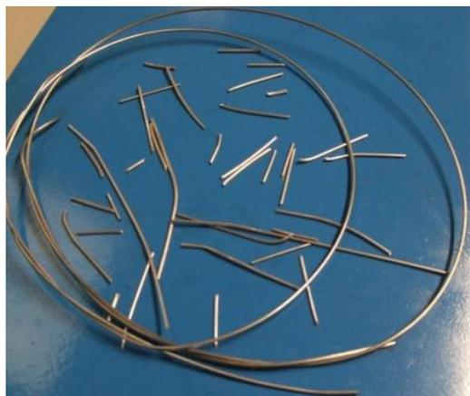
加工中に破断したマグネシウム合金ワイヤー
